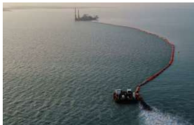
Рис. 1.3.2 Собранный плавучий трубопровод, подсоединенный к дноуглубительному снаряду
