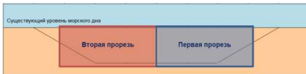
Рис. 1.3.3 Дноуглубительные работы на подходном канале
