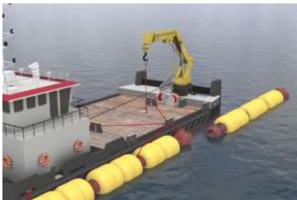
Рис. 1.3.2 Собранный плавучий трубопровод, подсоединенный к дноуглубительному снаряду
